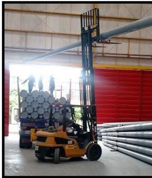
*Ilustración 4 Cargue de postes con montacargas*
