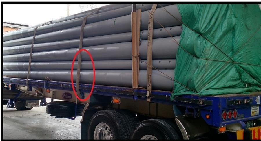
*Ilustración 4 Elementos de sujeción de carga*
